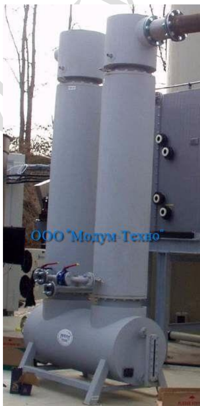
Конденсатор легкой фракции (с двумя блоками конденсации)
